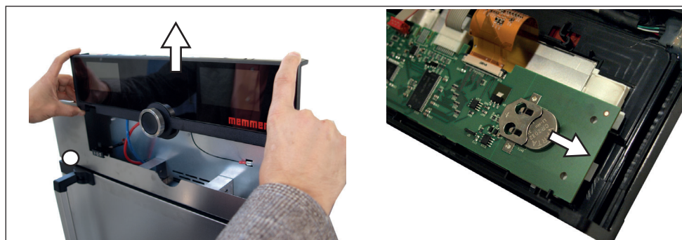
afb. 26 Het verwijderen van de lithiumaccu
