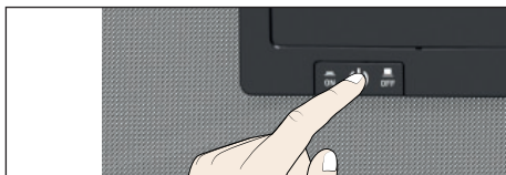
afb. 1 Het apparaat met de hoofdschakelaar uitschakelen
