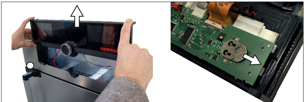
afb. 26 Het verwijderen van de lithiumaccu
